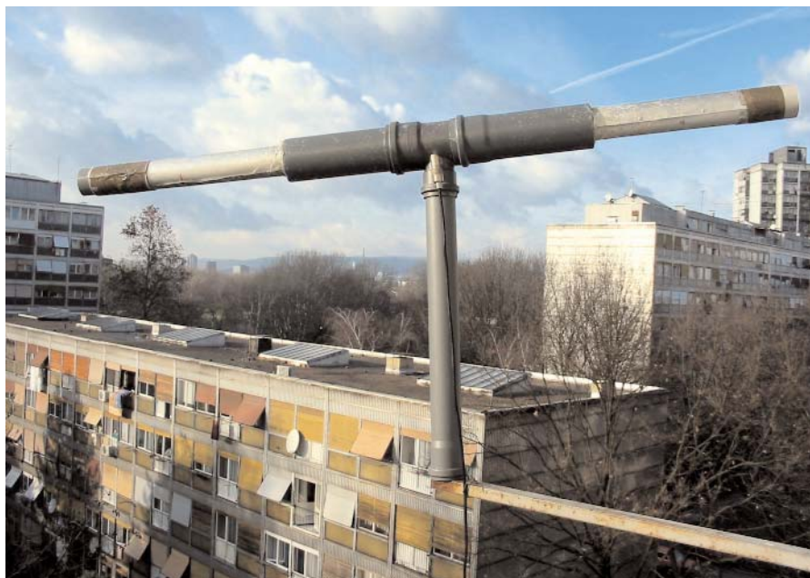
Slika 1. – Postavljena antena 9A4ZZ bipol za 40-metarski opseg
